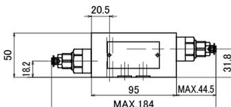
(注記)Fの場合、Aポート側リリーフ弁の調整ネジを調整すればBポート圧力、Bポート側リリーフ弁の調整ネジを調整すればAポート圧力の調整が行なえます。
