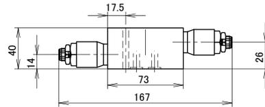
(注記)Fの場合、Aポート側リリーフ弁の調整ネジを調整すればBポート圧力、Bポート側リリーフ弁の調整ネジを調整すればAポート圧力の調整が行なえます。
